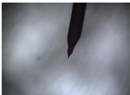
Fig. Attaque électrochimique d'un fil d'or dans une solution aqueuse de HCl 10%. La production de chlore gazeux contre l'électrode conduit à des pointes de piètres qualités au cours de nos essais.
